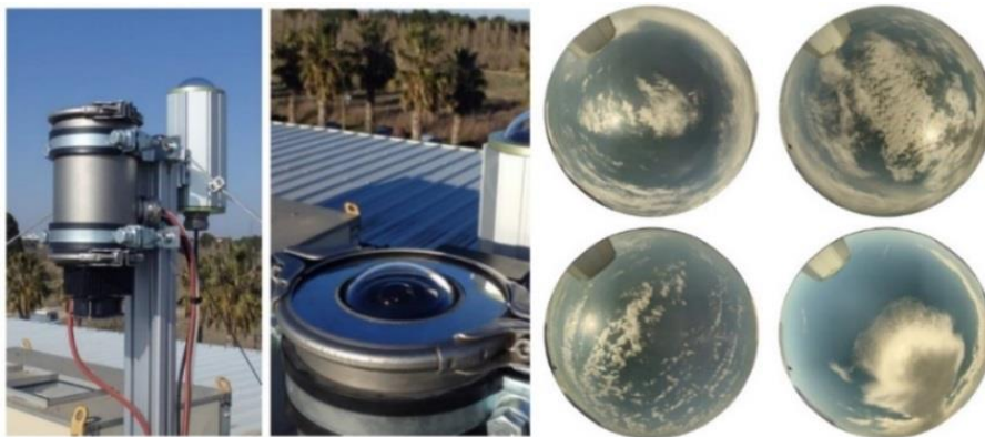
Figure 1. Le PROMES Sky Imager (PSI) installé au laboratoire PROMES-CNRS.
